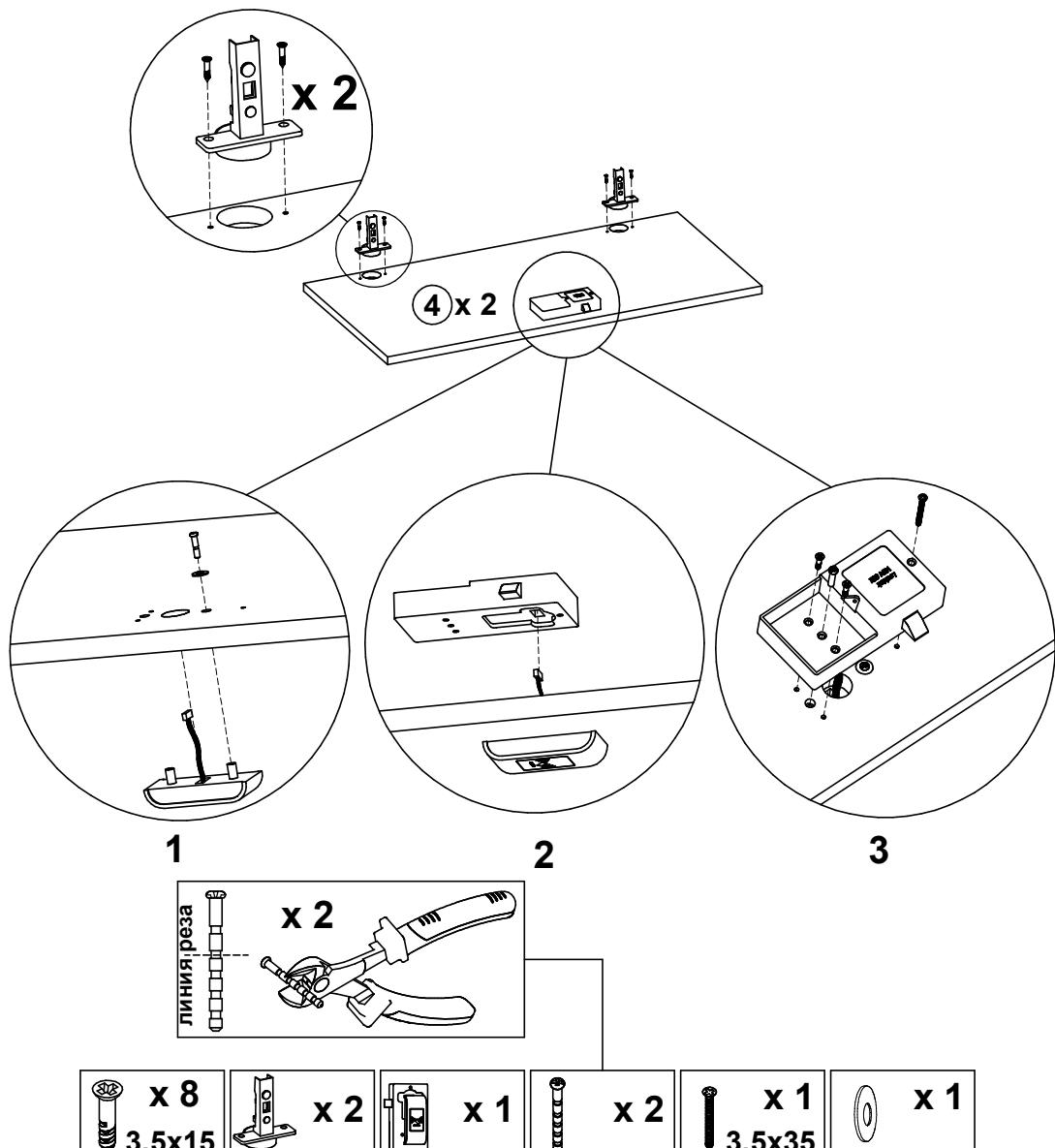
\* - Для установки замка использовать винты и саморезы из комплекта, идущего с замком.
